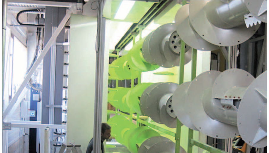
Zusammen mit der Pulverbeschichtung werden mit dem OR 6000 Schichtsystem über 6.000 Stunden NSS erreicht und auch viele Normen im maritimen Bereich.
