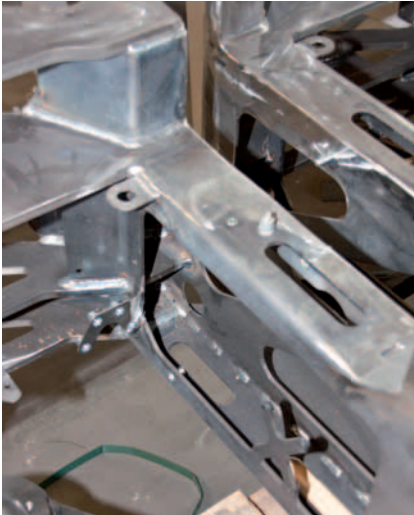
Vor dem Strahlen sind deutlich Oxidation und Zunder vom Schweißen zu erkennen.
