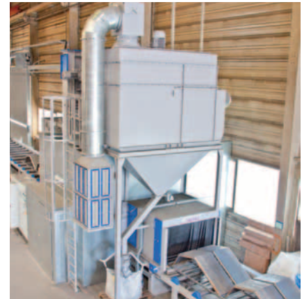
Der abwärts gerichtete Luftaustritt und die Schallschutzeinhausung senkt den Lärmpegel.
