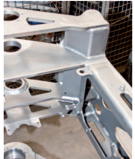
Selbst komplexe Konstruktionsbauteile werden bis in die Ecken perfekt gestrahlt.
