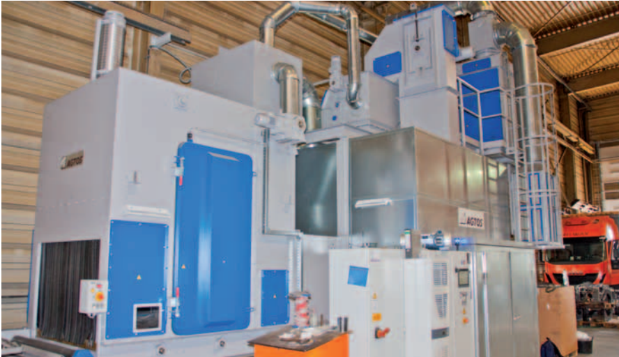
Die Strahlanlage verfügt über eine kombinierte Abblas-Bürsteinheit mit automatischer Höhenverstellung zur Strahlgut-Rückgewinnung.
